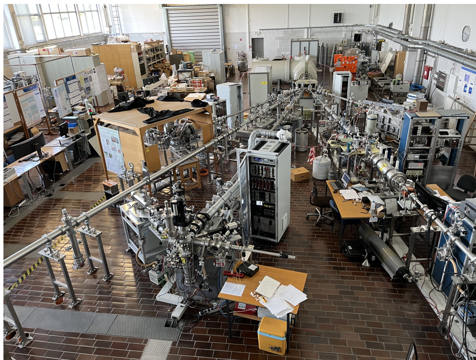
Slika 9: Fotografija eksperimentalne hale s pospeševalnikom in žarkovnimi linijami s posameznimi merilnimi postajami.
